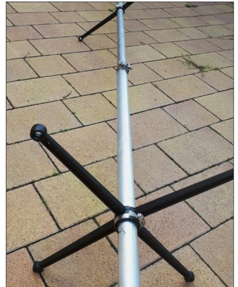
**Bild 4: Am 20-m-Strahler sind die Spreizer befestigt. Der untere hält die vier restlichen Strahler, der obere Spreizer nur die für 17 m und 15 m.**
