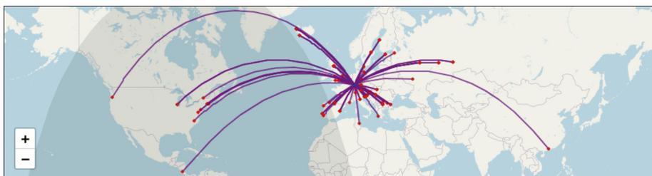
**Bild 3: Registrierung des CW-Signals von DA0EMV im Reverse Beacon Network auf 20 m**
